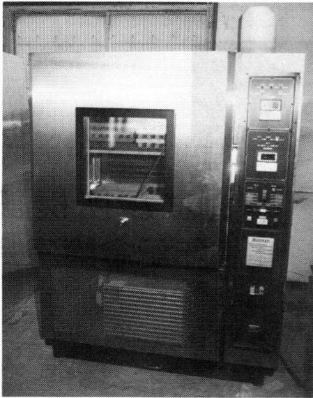
写真-1 火源用恒温恒湿養生装置
