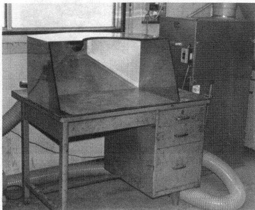
写真-7 粉塵除去装置 (ステンレス製フード、収塵器により構成)
