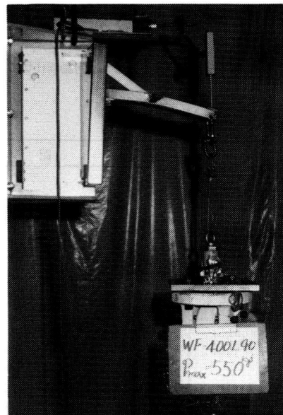
写真-9 試験体記号WF-400 L 90 の破壊状況（アームが曲げ破壊する）
