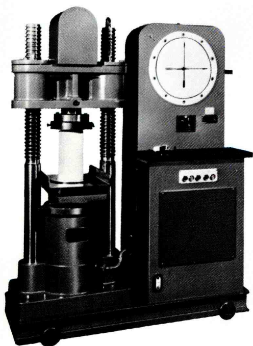
油圧式 100ton 耐圧試験機
