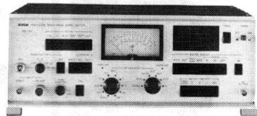
IEC Type0, 0.5~400kHz±3dB, 20~180dB, 10μ~100V, 対数・リニア表示, ダイナミックレンジ・80dB
