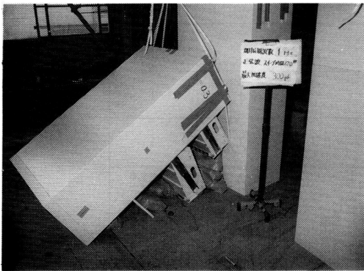
写真-1 鋼製オープンファイルキャビネットの転倒状況
