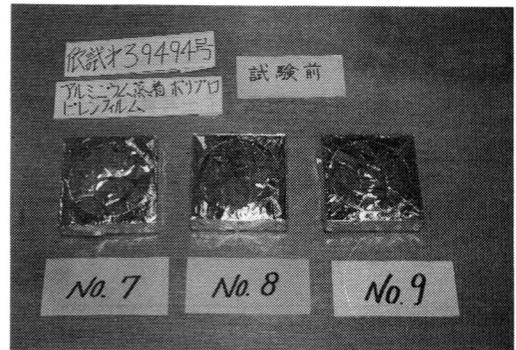
写真-3 試験体番号7～9のアルミニウム蒸着ポリプロピレンフィルム外被付グラスウールの試験前の状況
