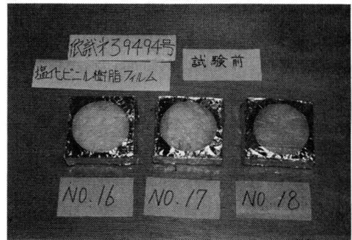
写真-6 試験体番号16～18の塩化ビニル樹脂フィルム外被付ガラスウールの試験前の状況
