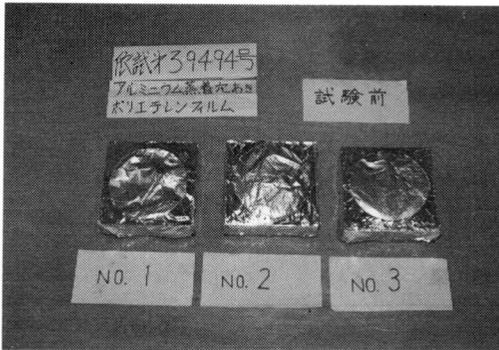
写真-1 試験体番号1～3のアルミニウム蒸着穴あきポリエチレンフィルム外被付グラスウールの試験前の状況
