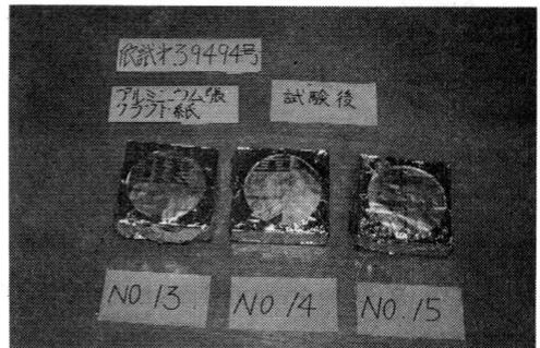
写真-11 試験体番号13～15のアルミニウム張クラフト紙外被付ガラスウールの試験後の状況
