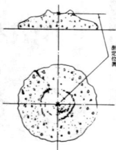
図-3 中央部の外側に噴火山の突起のような突起があり、しかも中央部よりも盛り上げられている場合は突起の突起に接れるので中央部の高さが変化しないように測定する。粗骨コンクリートの場合などにはこの形状を示すことが多い。
