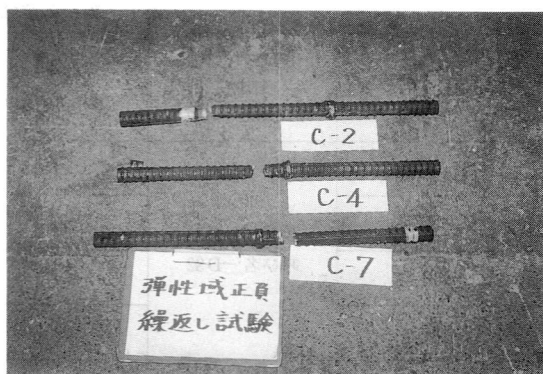
写真8 試験体記号C-2, C-4, C-7の破断状況
