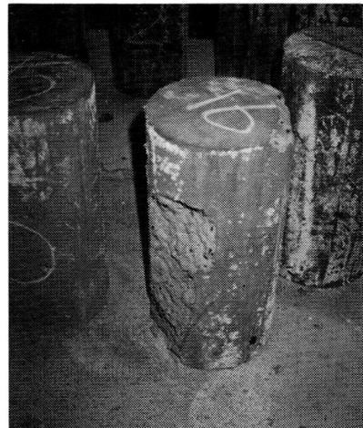
写真5 加熱終了後の供試体の状況 (実験II: 爆裂しているのが、硬質砂岩、水セメント比60%、含水率6%)
