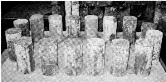
写真2 加熱終了後の供試体の状況 (実験II)
