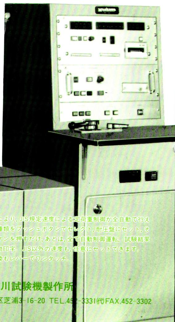
前川独自の機構により、JIS規定速度による定荷重制御が全自動で行えます。サンプル種類をプッシュボタンでセレクト、耐圧盤にセット、そしてスタートボタンを押すだけ、あとは、全て自動制御運転、試験結果もプリンタに自動印字。JIS以外の速度も、任意にセットできます。自動/手動の切換もレバーでワンタッチ。
