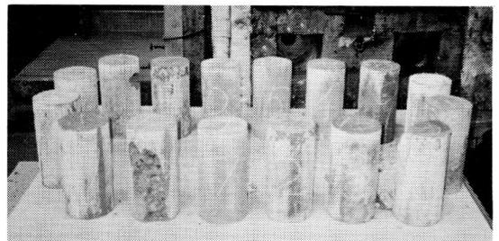
写真6 加熱終了後の供試体の状況 (実験III)
