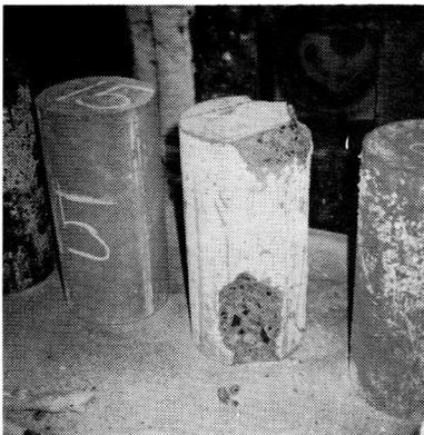
写真3 加熱終了後の供試体の状況 (実験II: 爆裂しているのが、硬質砂岩、水セメント比25%、含水率4%)
