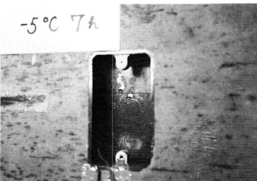
写真16 試験体No.6(外気-5°C, 7h後の結露状況)
