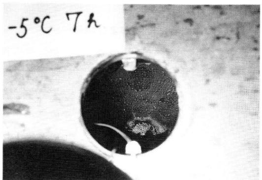
写真18 試験体No.8(外気-5°C, 7h後の結露状況)
