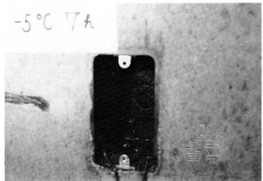
写真13 試験体No.3(外気-5°C, 7h後の結露状況)
