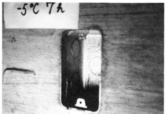
写真19 試験体No.9(外気-5°C, 7h後の結露状況)
