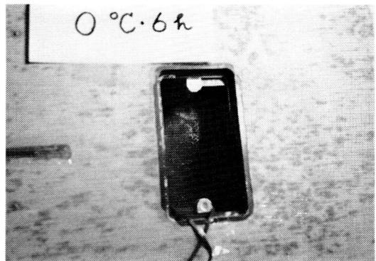
写真6 試験体No.7(外気0°C, 6h後の結露状況)
