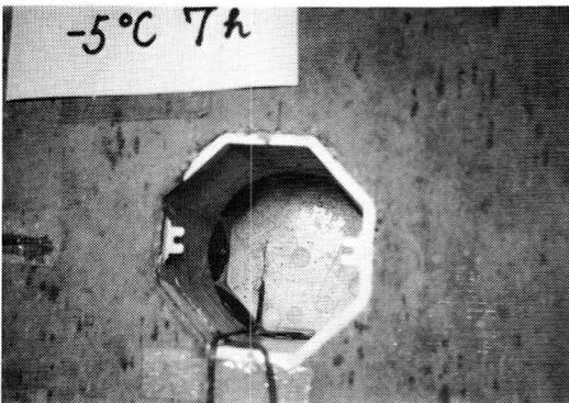
写真15 試験体No.5(外気-5°C, 7h後の結露状況)
