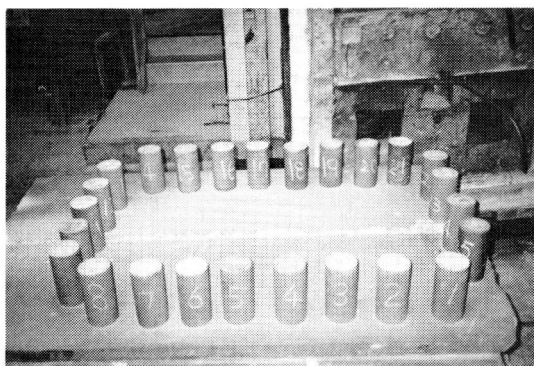
写真1 加熱終了後の供試体の状況 (標準×1/3加熱: 実験Ⅰ)
