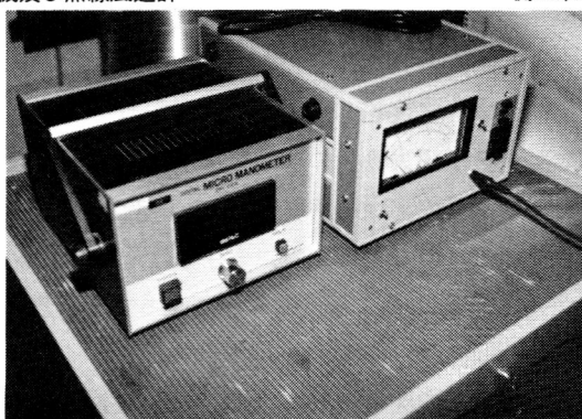
写真9 試験装置（気密性能試験）熱線風速計及びデジタルマイクロメーター
