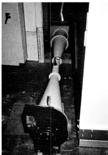
写真7 試験装置（気密性能試験）ベンチュリ管、送風機及び熱線風速計
