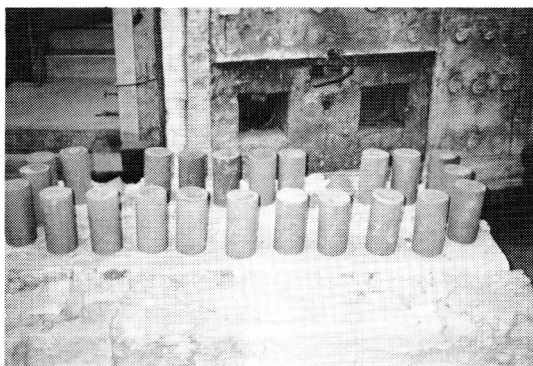
写真4 加熱終了後の供試体の状況 (標準×1/2加熱: 実験Ⅱ)
