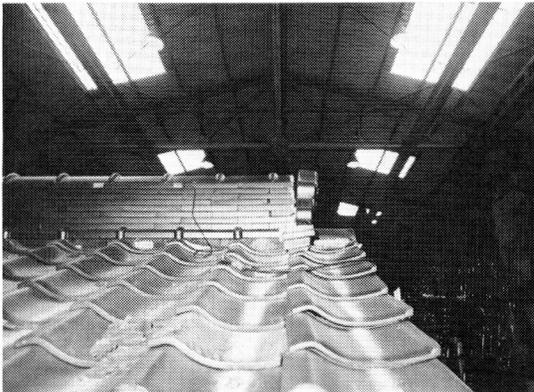
写真10 試験体K2の加振終了後の状況（試験記号EW-1000；鬼がわら①の面外方向の倒れ）
