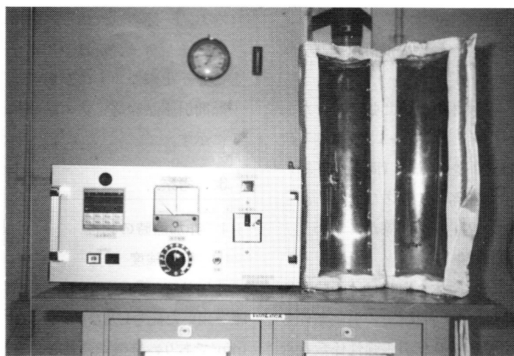
写真1 加熱装置（左：調節計、右：加熱炉）
