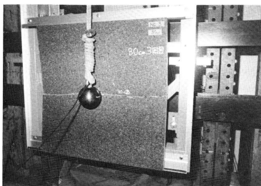
写真2 鋼球（10kg）衝撃試験の実施状況
