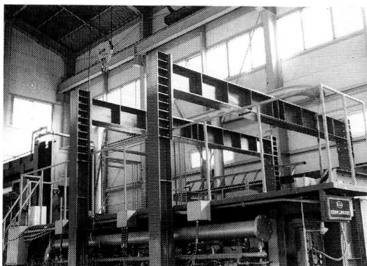
床・はり・屋根用の試験装置
