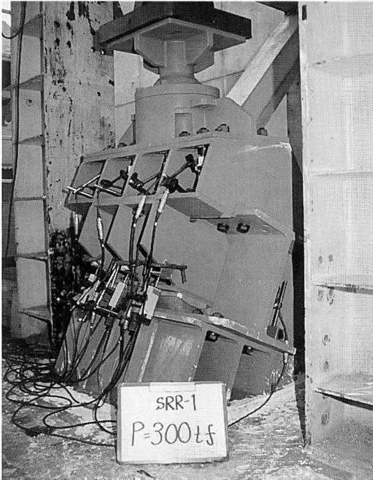
写真1 試験体記号SRR-1の試験実施状況（異状なし）
