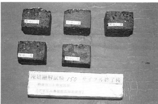
写真8 凍結融解150サイクル終了後の試験体
