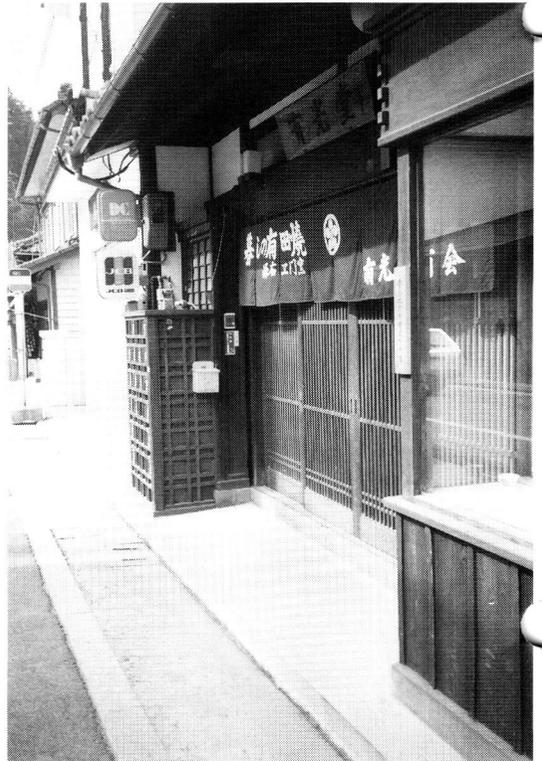
写真6 景観を配慮して、戸外ガスボンベやエアコン機器類を板などで覆っている例。(有田町)
