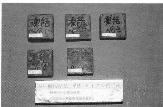
写真6 凍結融解90サイクル終了後の試験体
