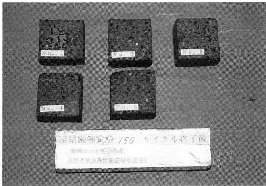
写真9 凍結融解150サイクル終了後の試験体
