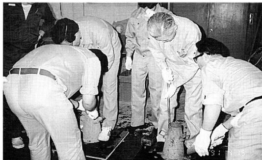
建材試験センターにおけるコンクリートの調合実験
