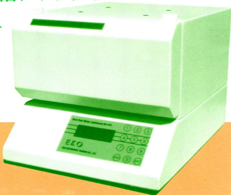
測定方式：熱流計法
