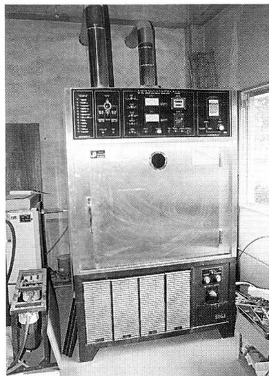
写真1 サンシャインウエザーメータ試験装置
