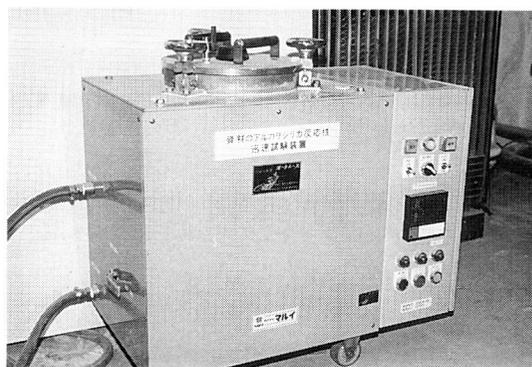
写真3 反応促進装置
