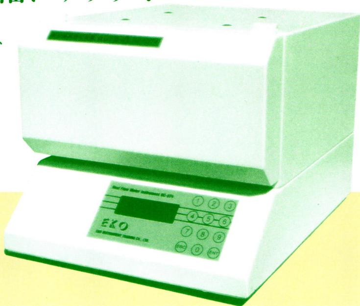
測定方式：熱流計法
