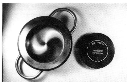
写真1 アンボンドキャッピングに用いる器具
