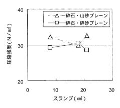
図1 スランプと圧縮強度
