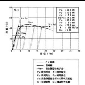
図3 荷重 - 変位包絡線の比較
