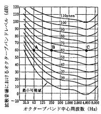
図3 オクタープパンドノイズに対する拡散音場の等感 度曲線
