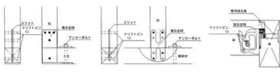
図2 1階隅柱の柱脚金物
