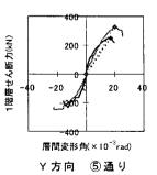
図7 層せん断力と層間変形角の関係 JMA神戸波125%(フェーズ2) 図8 包絡線の比較
