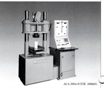
パソコン利用データ処理装置 コンクリート静弾性係数 **自動計測・データ解析システム** CAE-980
