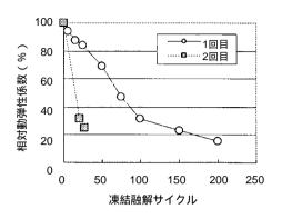
図3 凍結融解試験結果
