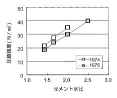
図2 セメント水比と圧縮強度
