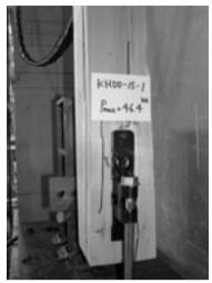
写真1 破壊状況 試験体記号: KHDD - 15 - 1 最大荷重: 46.4kN
