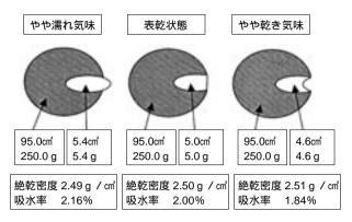
図5 骨材の含水状態と密度・吸水率
