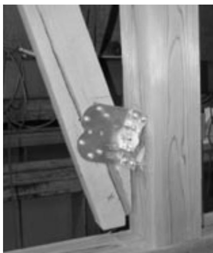
写真1 試験体A1の破壊
