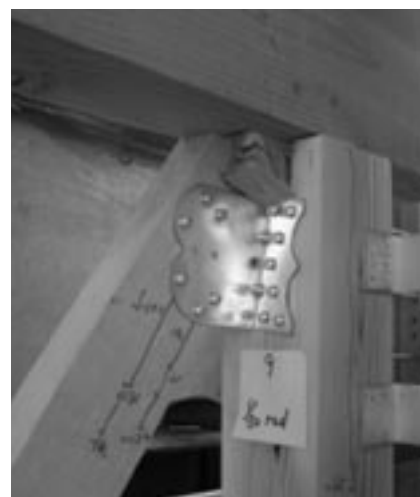
写真6 試験体C2の破壊
