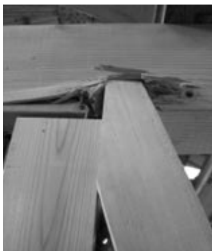
写真4 試験体D2の破壊
