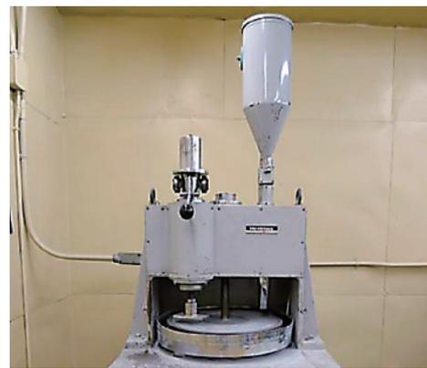
写真4 オルゼン式摩耗試験機 (JIS K 7205)
