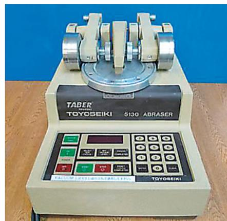
写真3 テーバー式摩耗試験機 (JIS K 7204)
