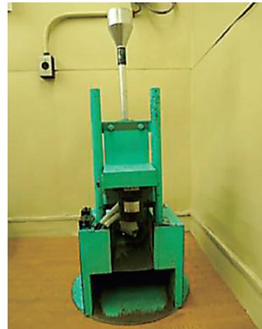
写真2 落砂摩耗試験機 (JIS A 1452)
