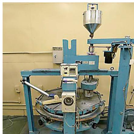
写真1 吉岡式摩耗試験機 (JIS A 1451)
