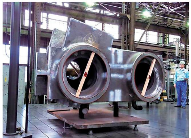
写真5 交差部仕口部鋳鋼の実物大試験体
