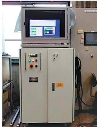
写真2 荷重制御装置
