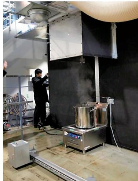
写真1 捕集率測定状況 (大阪ガス)
