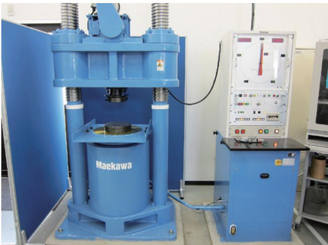
写真6 3000kN圧縮試験機
