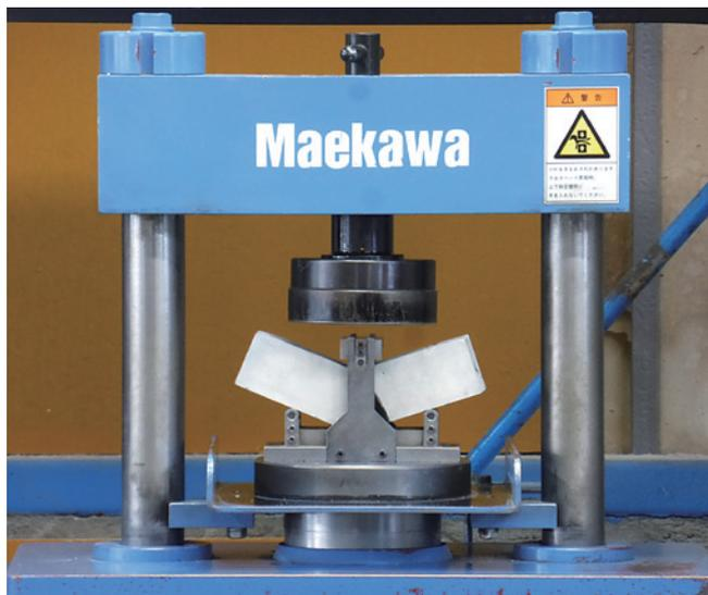
写真2 モルタル曲げ試験
