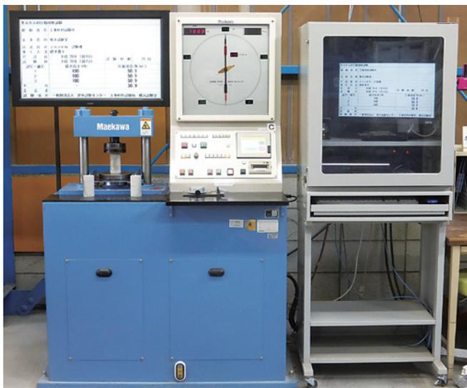
写真1 200kN全自動耐圧試験機
