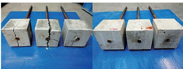
写真2 破壊状況(左: D25-JS, 右: D25-N)
