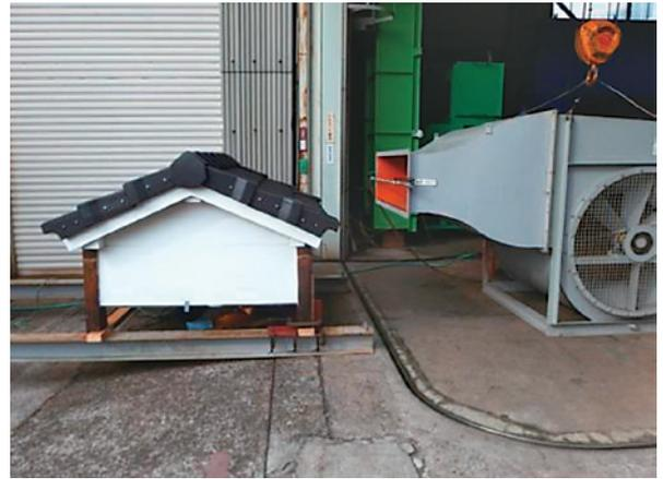
写真3 送風散水試験装置
