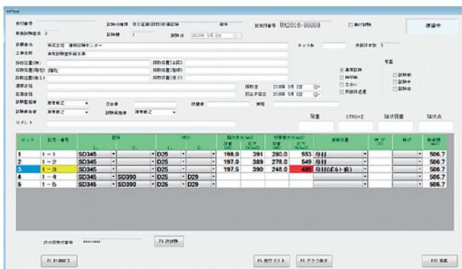
図2 鉄筋引張計測システム(試験計測画面)
