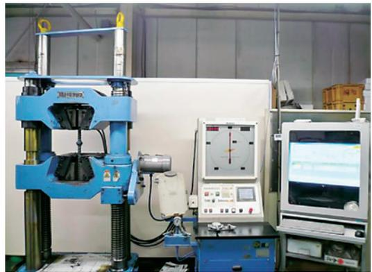
写真1 1000kN 万能試験機と鉄筋引張計測システム
