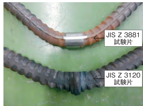
写真5 ガス圧接継手の曲げ試験片（試験後）
