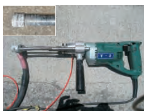
写真4 湿式二軸低騒音ドリル [ \phi 6.5\text{mm} ]
