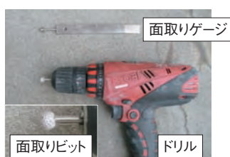
写真5 面取り作業用工具 [面取りビット、ドリル及び 面取りゲージ]
