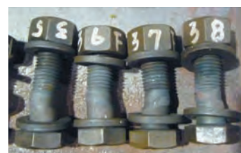
写真4 下フランジボルトの変形状況
