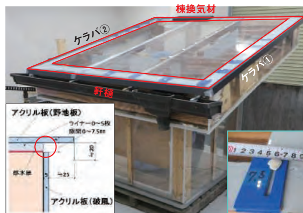
破風頂部と野地板の隙間 (写真3赤枠部)
