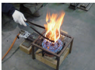
写真2 ガスバーナーによる火種の着火
