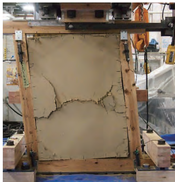
写真1 水平加力実験の状況
