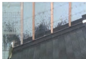
写真6 雨水浸入結果 (通気層上部構造：B) 実験時間5分
