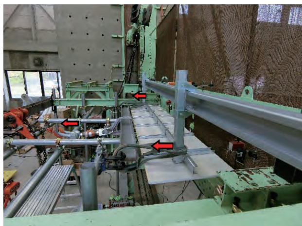
写真1 短手方向加力風景（ふところ300mm試験体）
