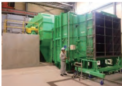
写真5 大型送風散水試験装置
