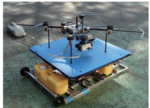
写真2 近接調査用ドローンシステム 7)
