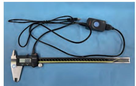
写真4 ノギス用USB通信機器
