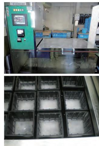
写真3 凍結融解試験状況
