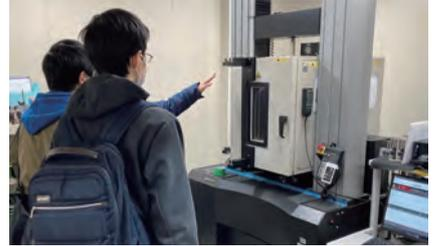
恒温槽付き定速型万能試験機
