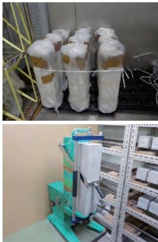
写真9 コンクリートの反応性試験状況<sup>8)</sup>
