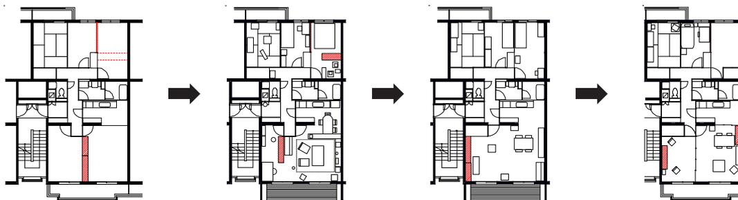
図2 移設可能収納壁、間仕切り壁を活用したある住戸の居住履歴
