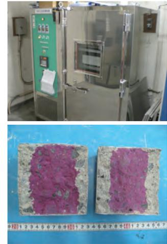
写真1 促進中性化試験状況<sup>2)</sup>
