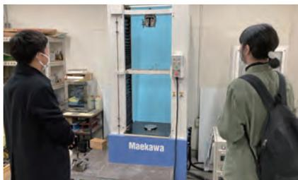
20kN 定速型万能試験機
