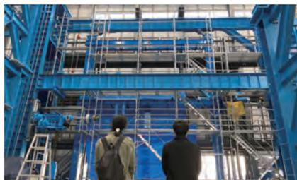
大型多層構面試験装置
