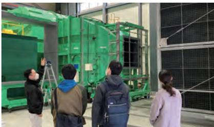
大型送風散水試験装置
