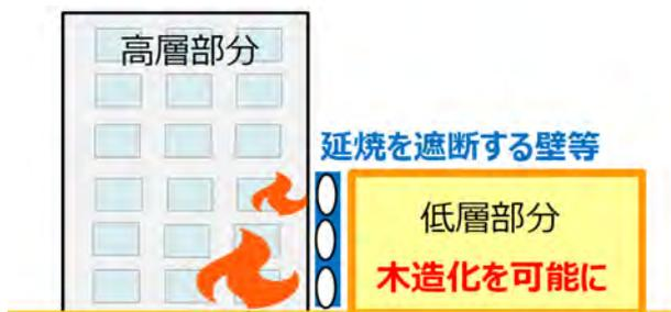
図3 別棟みなし規定のイメージ<sup>1)</sup>
