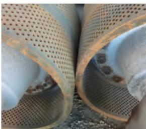
写真26 造粒型の成型機
