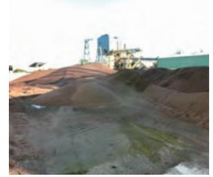
写真31 人工軽量粗骨材の貯蔵場所
