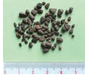
写真30 人工軽量細骨材
