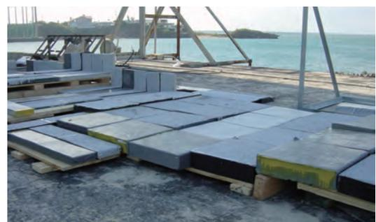
写真2 試験体の暴露試験の様子(沖縄)
