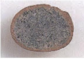
写真15 人工軽量骨材
