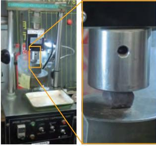
写真32 圧れつ荷重試験装置
