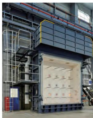
写真1 1号壁炉の外観
