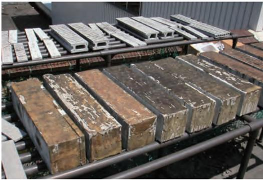
写真3 暴露試験に供した小型試験体と設置架台（北海道）
