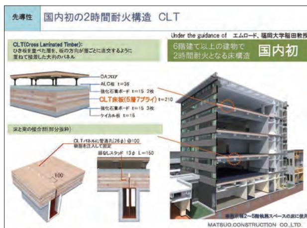
図2 松尾建設本社ビルの構造
