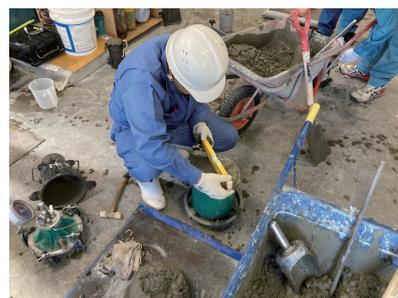
写真3 空気量測定の実習状況
