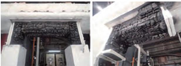
写真2 消火後の試験体状況：
