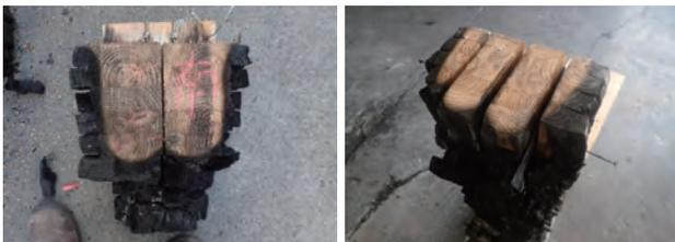
写真3 試験後の梁内部の状況：(左)一般部(右)接合部
