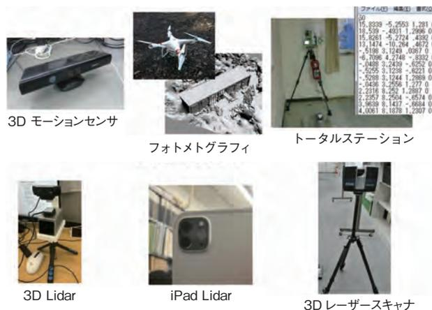
図5 3次元計測機器の多様化
