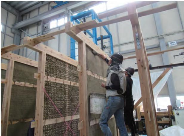
写真4 土塗壁の施工風景
