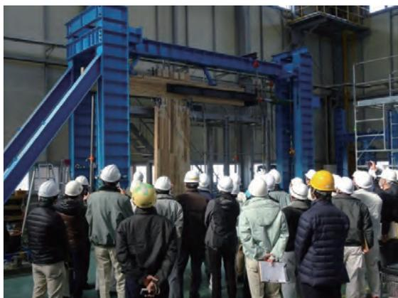
写真3 CLT耐力壁の面内せん断試験の様子
