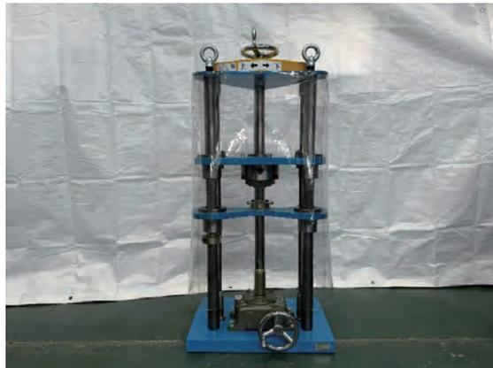
写真1 木質構造用ねじ試験装置
