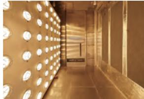
写真2 赤外線ランプ照射時の外気側の環境試験室内の様子
