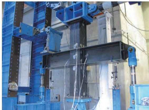
写真4 十字鉄骨接合部の試験の様子
