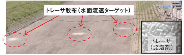
写真3 流速計測(PIV解析)用トレーサ散布
