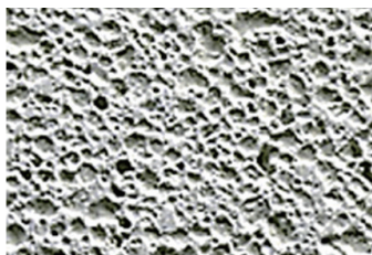
写真5 気泡コンクリートの空気(旭化成提供)
