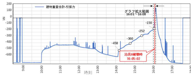
図6 建物重量合計-引抜き力(経時データ)
