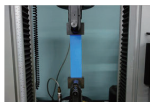
写真1 引張強さ及び伸び率試験状況
