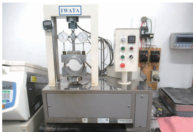
写真4 自動記録式載荷装置の外観
