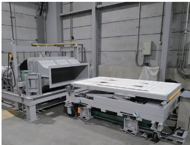
写真1 飛び火試験装置
