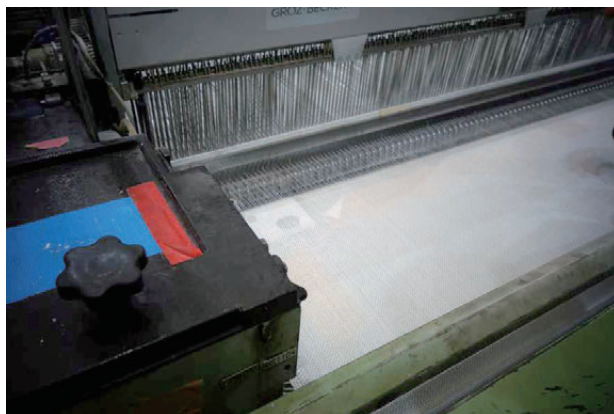
写真5 フラットヤーンを交互に織り込む工程
