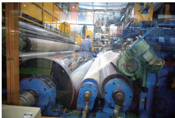
写真6 ラミネート材を流し、コーティングする工程
