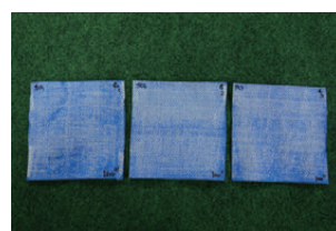
写真2 促進暴露処理後の試験片の例
