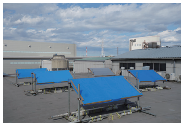
写真9 ブルーシートの屋外暴露試験 (草加市、建材試験センター屋上)
