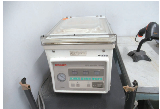
写真2 真空包装装置の外観
