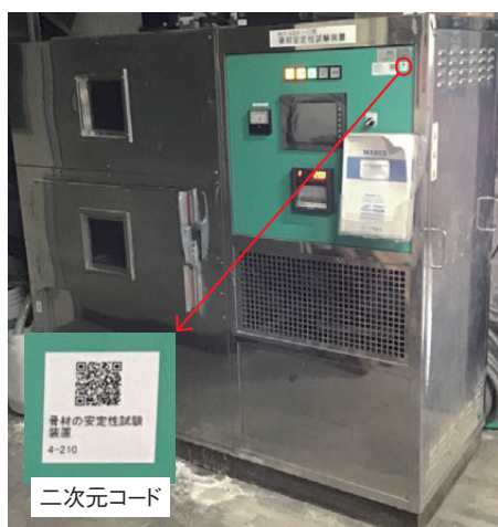
写真1 骨材の安定性試験装置
