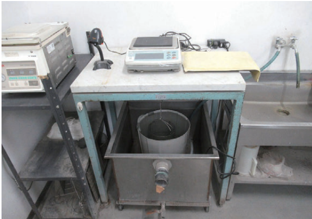
写真1 密度試験器具の外観
