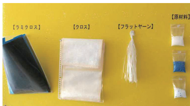
写真4 原材料から製品まで
