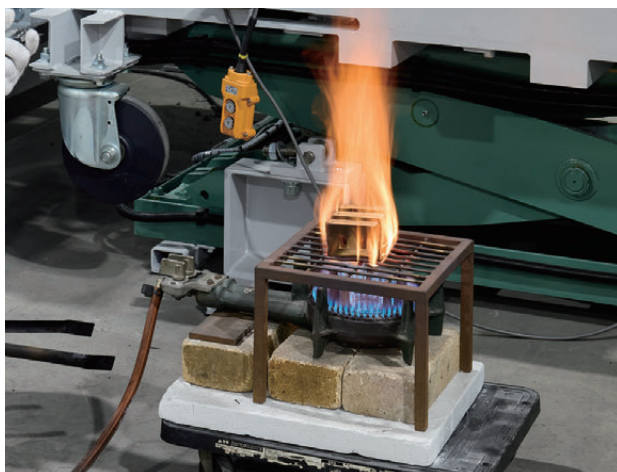
写真3 燃烧させたクリブの様子
