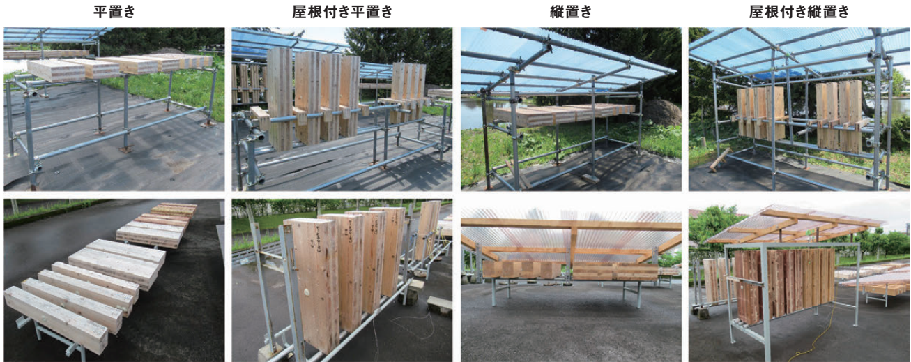
写真2 暴露試験体設置の様子(上:2022/5/18旭川試験体、下:2022/5/11都城試験体)
