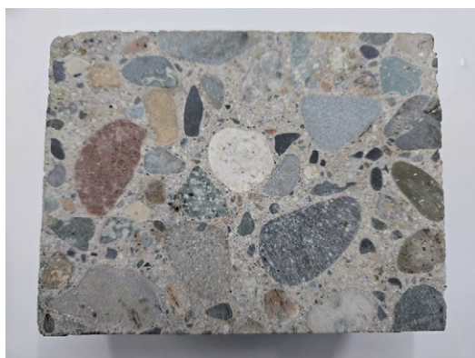
写真1 砂利コンクリートの内部の例
