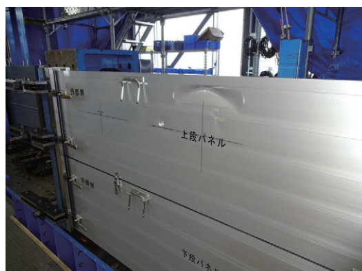
写真2 住宅内部での浸水の痕跡 試験体表面に残留変形
