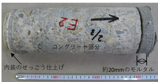
(b) 非爆心地側試験体「*1梁」の外観
