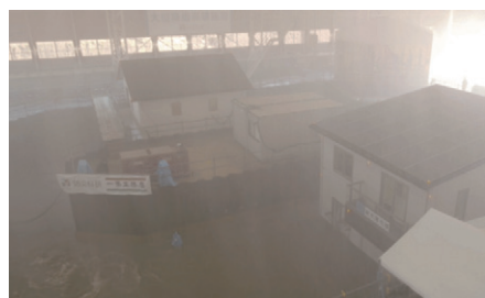
写真2 大型降雨実験施設における実大木造住宅の耐水害性能検証実験
