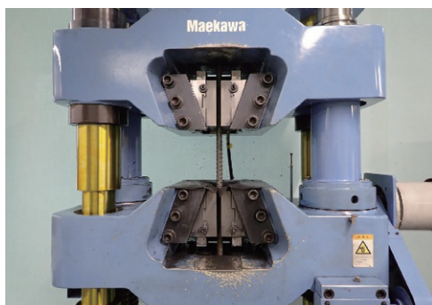
写真1 引張試験状況
