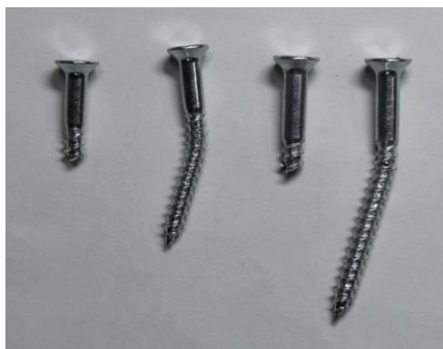
写真1 繰返し加力によって破断した木ねじ
