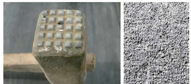
写真6 びしゃんの例とびしゃんたたきの例
