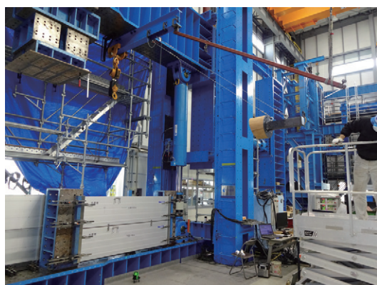
写真1 設定高さに吊り上げた加撃体
